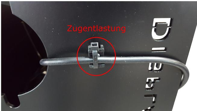
Befestigen Sie die Zugentlastung mittels der Schraube M4x16 und Sicherheitsschraube M4 unterhalb des Fußes. Legen Sie das Netzanschlusskabel durch die obere und untere Öffnung A und befestigen Sie es mittels Kabelbinder an der Zugentlastung. Zur Fixierung des Kabels innerhalb des Fußes liegen zwei Pads mit Kabelbinder bei.
