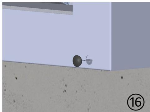
Befestigen Sie das Gehäuse mit den beiliegenden Schrauben (i) in den vorgebohrten Löchern.
